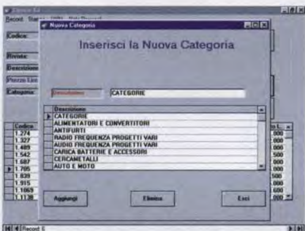
Fig.25 Tramite l'istruzione Nuova Categoria, che si trova nel menu Record, è possibile aggiungere altre categorie a quelle già inserite da noi in memoria.
